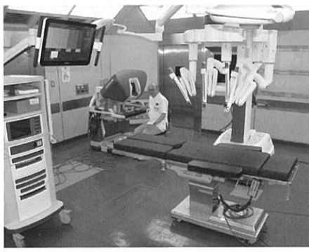
導入した「ダ・ヴィンチ」、中央奥がサージョンコンソール
